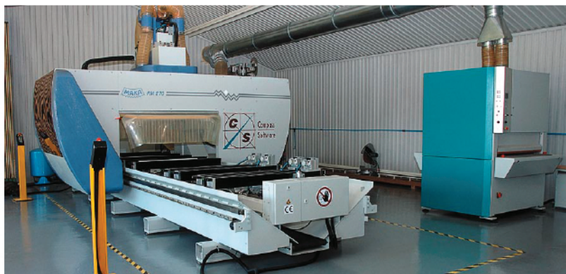
Des équipements de haute technologie, tel ce centre de traitement à commande numérique, permettent à l'artisan d'effectuer les tâches plus rapidement.
